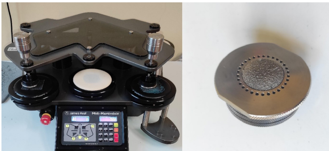
Rys. 6.4. Przyrząd James Heal Martindale oraz głowica z zamocowaną próbką cholewki Źródło: opracowanie własne.
