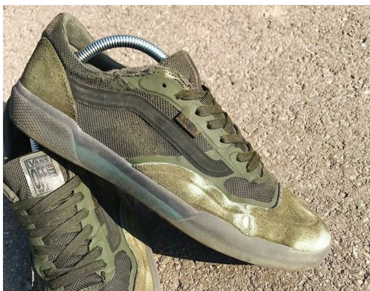
Rys. 1.7. Zmiany eksploatacyjne modelu Vans AVE podczas indywidualnych testów użytkowych
