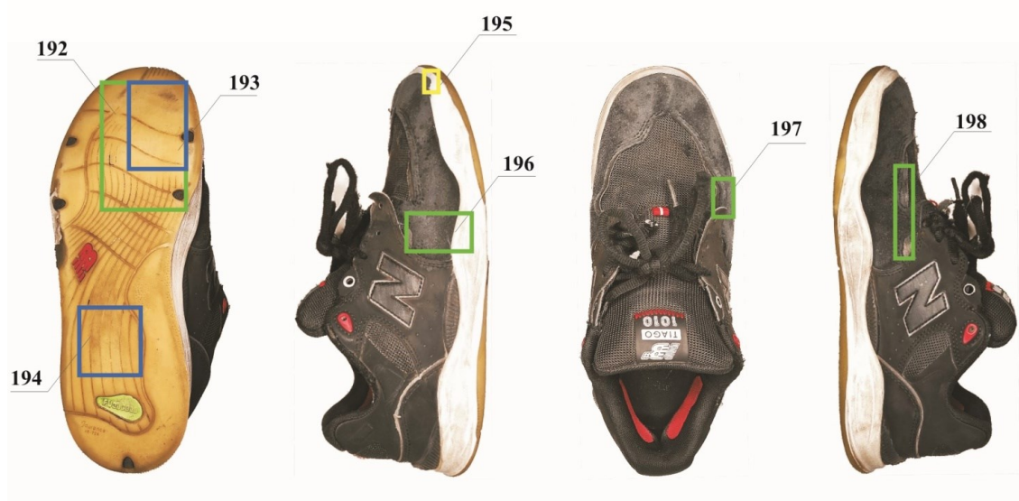
Rys. 18. Analiza graficzna uszkodzeń modelu New Balance 1010 Tiago. Numer porządkowy: 18
