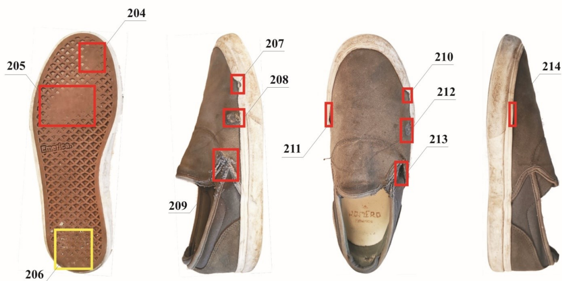
Rys. 20. Analiza graficzna uszkodzeń modelu Emerica Wino G6 Slip-on. Numer porządkowy: 20
