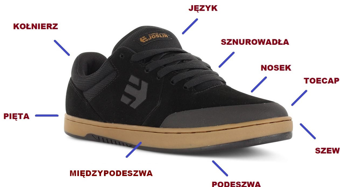
Rys. 2.1. Konstrukcja typowego buta deskorolkowego na przykładzie modelu Marana Michelin Joslin firmy Etnies
