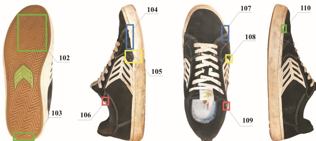
Rys. 10. Analiza graficzna uszkodzeń modelu Cariuma Cartiba Pro. Numer porządkowy: 10 Źródło: opracowanie własne.
