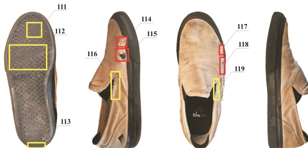
Rys. 11. Analiza graficzna uszkodzeń modelu Emerica Wino G6 Slip-on. Numer porządkowy: 11
