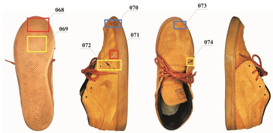
Rys. 6. Analiza graficzna uszkodzeń modelu Nike SB Janoski Mid. Numer porządkowy: 06 Źródło: opracowanie własne.
