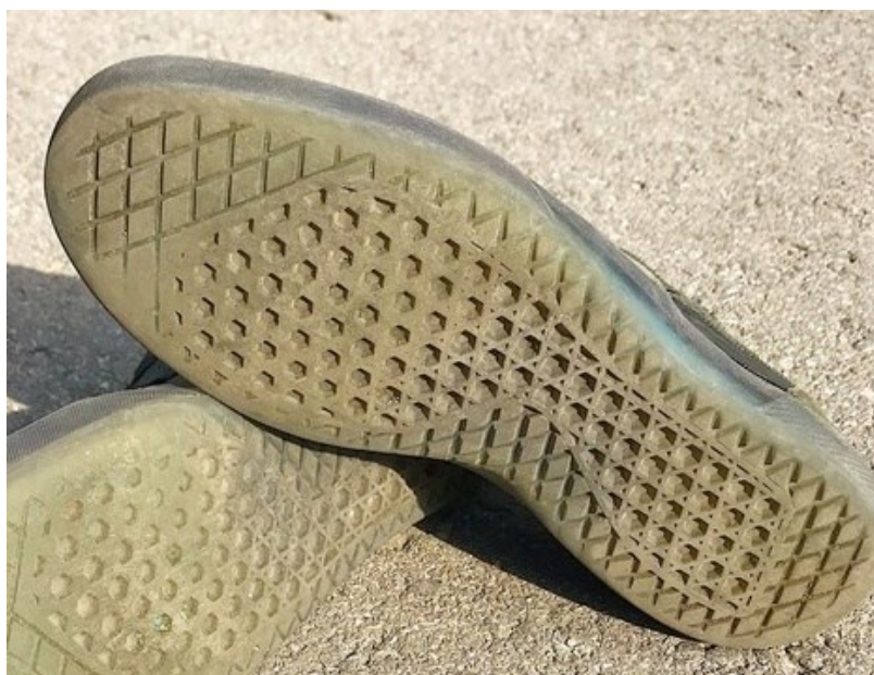
Rys. 1.8. Zmiany eksploatacyjne podeszwy modelu Vans AVE podczas indywidualnych testów użytkowych
