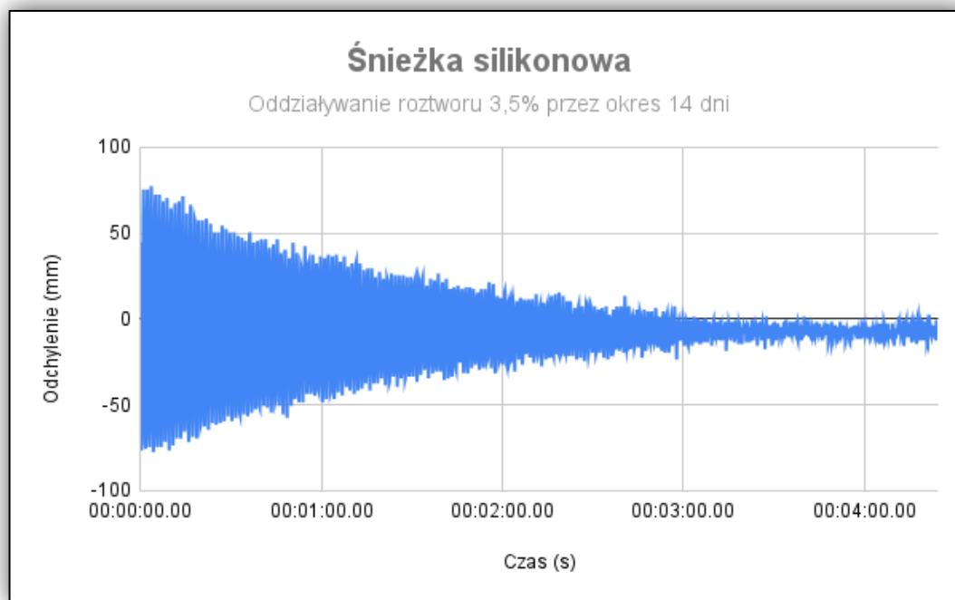
Rysunek 117. Przebieg tłumienia wahadła Königa dla srebrzanki silikonowej marki Śnieżka (PB10) po narażeniu na oddziaływanie wody oraz 3,5% NaCl w czasie 336h.
