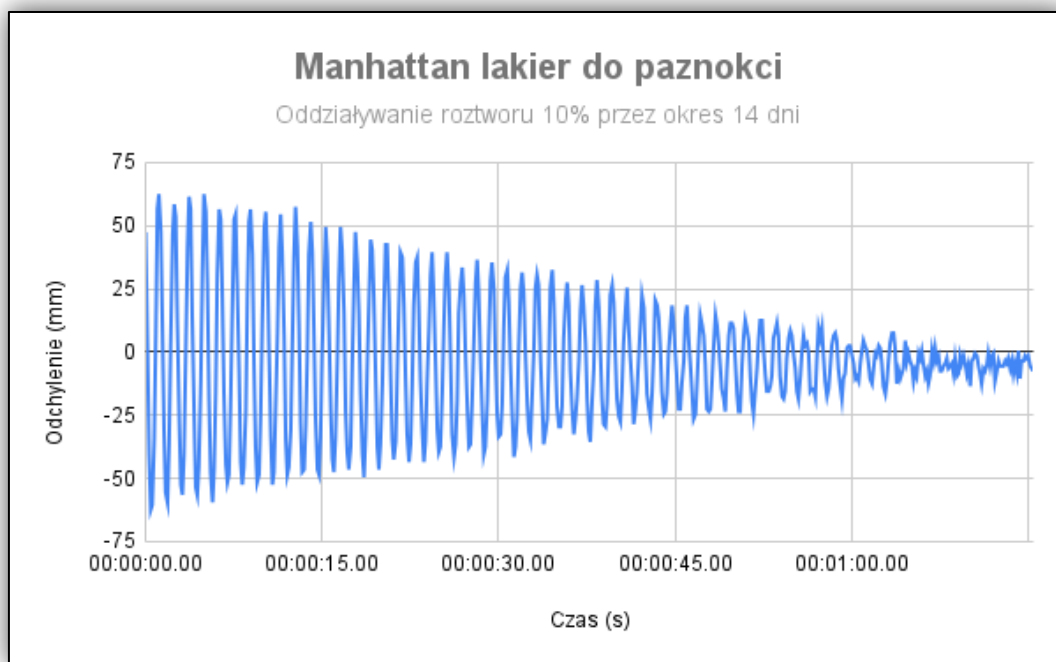
Rysunek 82. Przebieg tłumienia wahadła Königa dla lakieru do paznokci marki Manhattan (PB11) po narażeniu na oddziaływanie 10% NaCl w czasie 336 godzin.
