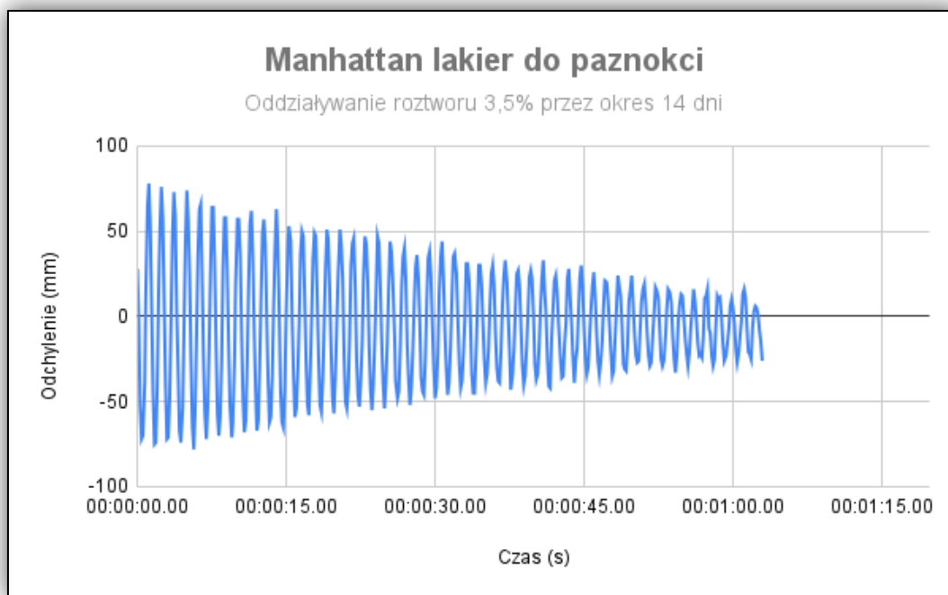
Rysunek 118. Przebieg tłumienia wahadła Königa dla lakieru do paznokci marki Manhattan (PB11) po narażeniu na oddziaływanie wody oraz 3,5% NaCl w czasie 336h.
