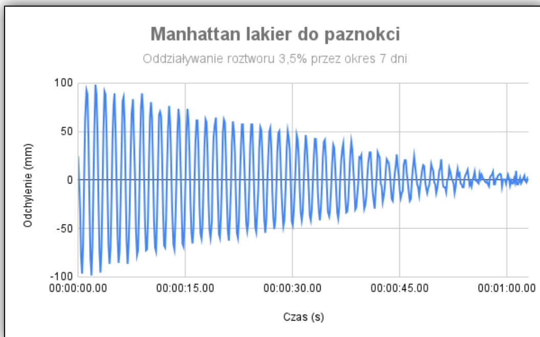
Rysunek 106. Przebieg tłumienia wahadła Königa dla lakieru do paznokci marki Manhattan (PB11) po narażeniu na oddziaływanie 3,5% NaCl w czasie 168h.
