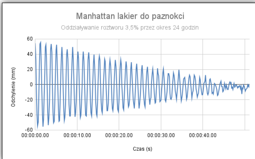
Rysunek 94. Przebieg tłumienia wahadła Königa dla lakieru do paznokci marki Manhattan (PB11) po narażeniu na oddziaływanie 3,5% NaCl w czasie 24h.
